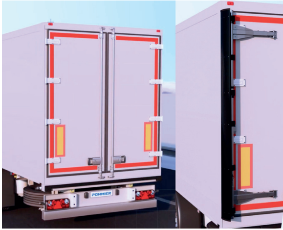
FIGURE 3. Système de déflecteur aérodynamique Airwin développé par l'entreprise Pommier
